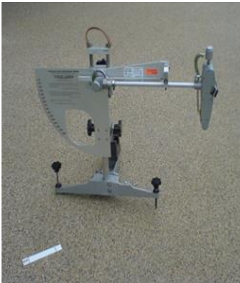
Dispositivo de Pêndulo Britânico conforme norma EN 13036-4
