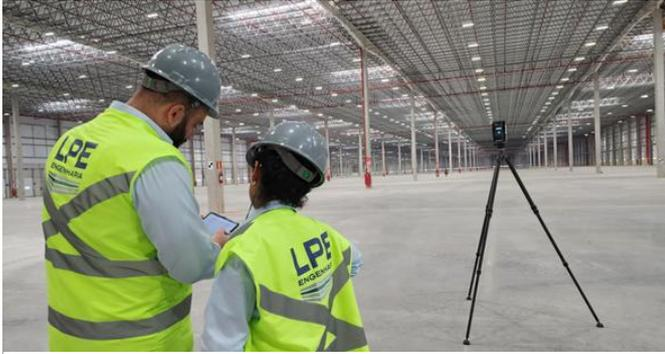
Figura 01 – Utilização de Laser Scanner 3D
