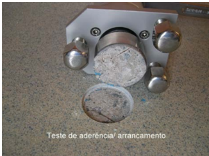
Fig. 3 - Teste de aderência/arrancamento
